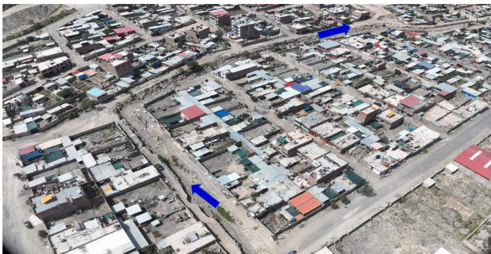
IMAGEN 01: SE OBSERVA EL CAUCE DE LA QUEBRADA S/N SIN PROTECCION EN AMBAS MARGENES PARA LA CONSTRUCCION DE MURO DE CONTENCIÓN Y PROTEGER A VIVIENDAS Y POBLACION
